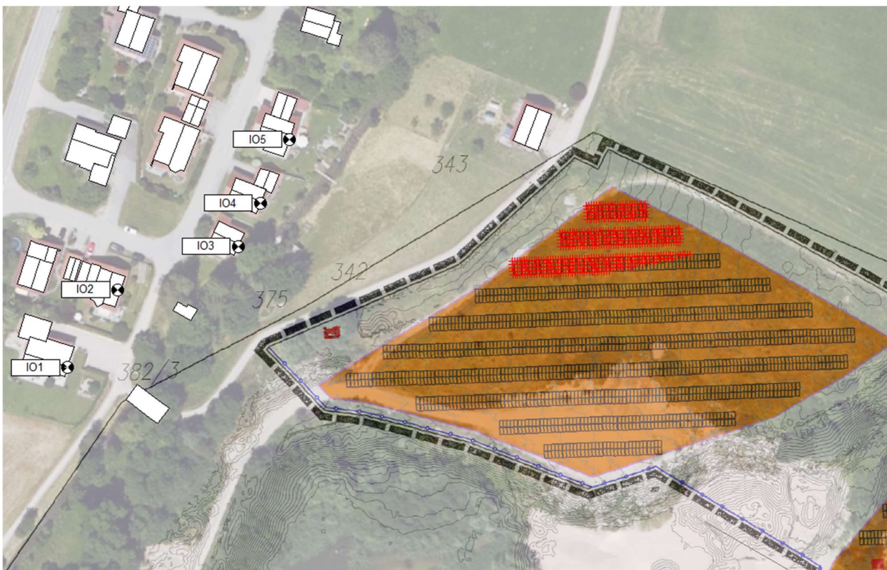
Abb. A2: Geplante Solaranlage mit Darstellung der Quellbereiche mit potentiellen Reflektionen am IO2
