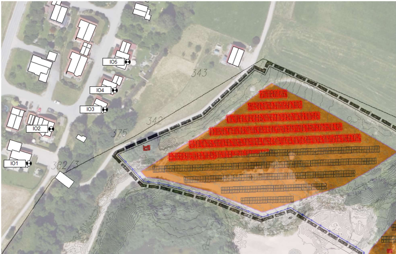
Abb. A1: Geplante Solaranlage mit Darstellung der Quellbereiche mit potentiellen Reflektionen am IO1
